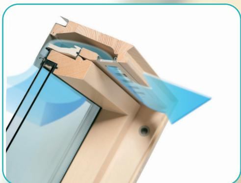
Поток воздуха регулируется вручную. Пропускная способность вентклапана V10 до 9 м<sup>3</sup>/час, вентклапана V22 до 31 м<sup>3</sup>/час при разнице давлений 10 Па. Удобная задвижка позволяет вручную регулировать (уменьшать или увеличивать) поток свежего воздуха. Размер впускных отверстий и дополнительный фильтр исключают возможность проникновения в комнату пыли и насекомых. Вентклапаны V10 и V22 могут использоваться только в помещениях с исправной вентиляцией.
