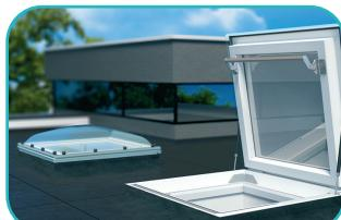
Окно DRC обеспечивает свободный выход на плоскую крышу. Специальные петли и удобная ручка позволяют открывать створку люка до 60-80°, в зависимости от размера окна. Газовые пружины облегчают управление створкой, а также удерживают ее в зафиксированном положении, защищая от случайного закрывания. На профилях люка установлены противоскользящие накладки.
