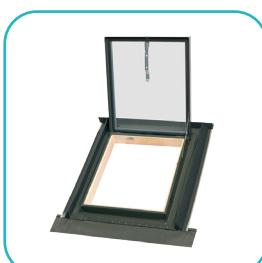
Крышка, оснащенная стеклопакетом с двумя закаленными стеклами и газовыми пружинами, откидывается по верхним петлям на угол до 120° и может фиксироваться в положении проветривания.
