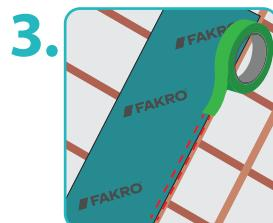
Примыкание пленок к строительным конструкциям.
