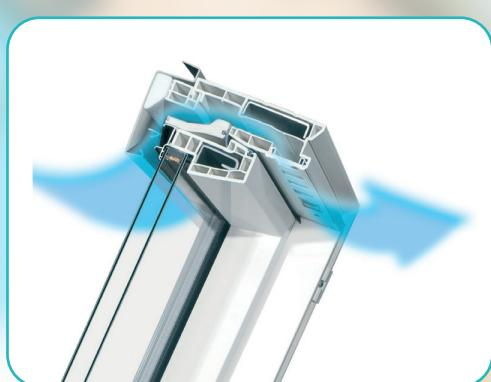
Вентиляционные клапаны V35, V40 располагаются в неподвижной части рамы и имеют лабиринтообразную форму, где поток воздуха регулируется вручную. В помещение воздух попадает уже теплым. Пропускная способность вентклапана V35 до 41 м<sup>3</sup>/час, V40 до 49 м<sup>3</sup>/час при разнице давлений 10 Па. При неправильной работе вентиляции в здании вентиляционный клапан работает на отток, выводя наружу использованный влажный воздух из помещения.
