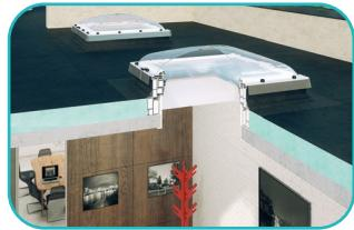
Конструкция окна представляет собой антивандальный морозостойкий стеклопакет P2 и купол из поликарбоната, стойкого к воздействию атмосферных явлений и механических повреждений. Купол может быть прозрачным (D\_C-C) или матовым (D\_C-M). Купол изготавливается с двумя типами стеклопакетов: с антивандальным однокамерным стеклопакетом P2 либо с трехкамерным стеклопакетом U8 (VSG).
