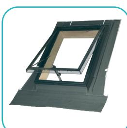
Крышка из поликарбоната (3 мм), стойкая к воздействию окружающей внешней среды, откидывается на угол до 180°, обеспечивая свободный выход на крышу. Имеет возможность проветривания, благодаря двум положениям фиксации.
