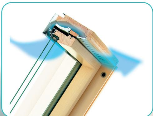
V40P - модель вентиляционного клапана с пропускной способностью до 49 м<sup>3</sup>/ч, которая позволяет оптимизировать приток свежего воздуха в помещение за счет автоматического частичного закрывания в случае высокой разницы давлений. Благодаря лабиринтообразному строению клапана перемешивание холодного воздуха, поступающего с улицы, с теплым воздухом происходит внутри вентклапана, что предотвращает образование конденсата на внутренней стороне стеклопакета.
