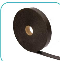
Уплотнительная лента используется для защиты стропильных ног или сплошного основания от проникновения дождевой и талой воды через отверстия, образовавшиеся в результате крепления контррейки с помощью гвоздей или саморезов.
