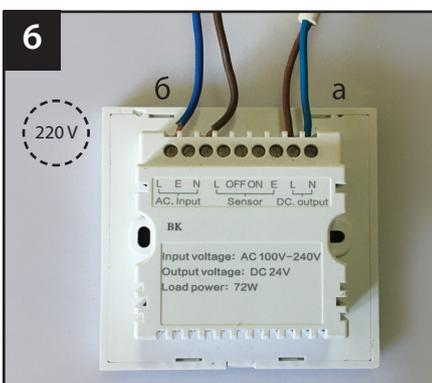
6 а) Подключите блок управления к приводу (клеммы DC input).
