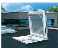
DRC – окно-люк с куполом, оборудованный антивандальным стеклопакетом P2. Купол может быть прозрачным или матовым. Окна 90x90 и 100x100 см открываются на угол до 80°, в размерах 90x120 и 120x120 см – до 60°. Газовые амортизаторы облегчают управление створкой и удерживают её в зафиксированном положении.
